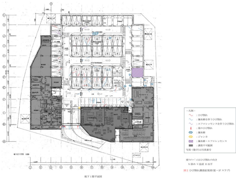
図7：地下1階躯体のひび割れ状況
